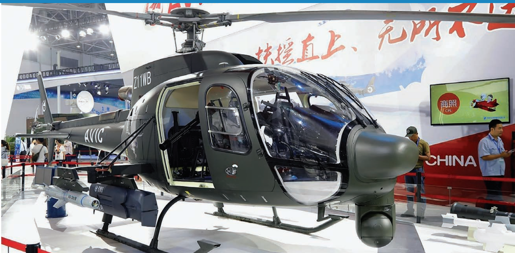
„Куанг” – са шестбоцевним мишраљезом, на носачима има противоклојну ракету и беспилотну лешелицу са склољеним крилима
