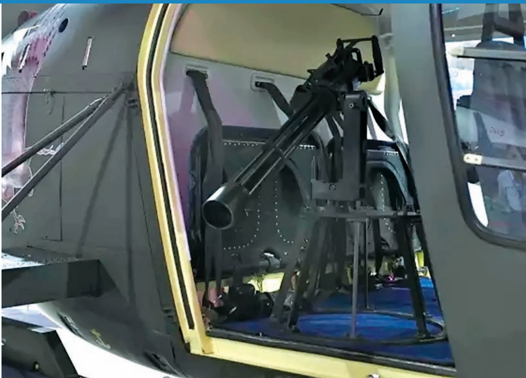
Митраљез „џианше“ CS/LM12 7,62 mm са 6.000 мечака у минути на бочној страни кабине
